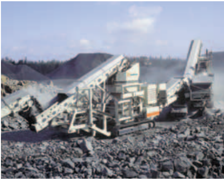
Planta trituradora móvil Nordberg LT300GP en una aplicación de trituración móvil en tres fases en Finlandia.
