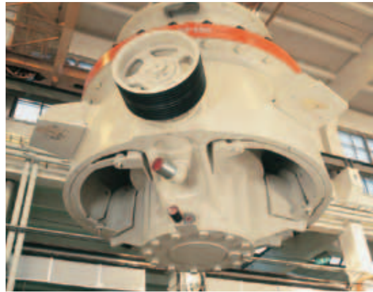
Las trituradoras de cono GP presentan una altura de instalación reducida gracias al diseño optimizado del pistón.
